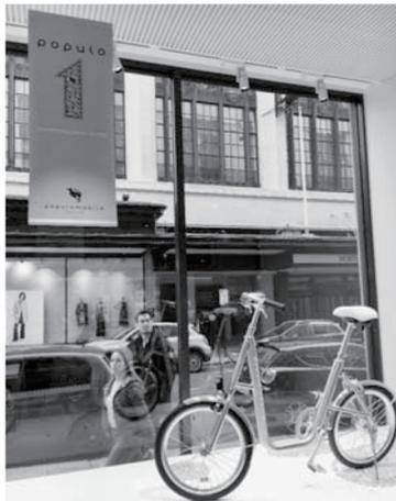
点として外務省が英国、米国、ブラジルに設立。ロンドンには自転車用ハイウエーが整備されるなど、自転車人気が高い。榛葉鉄工所はフレームを部分的に二重管構造とし、強度とデザイン性の両立に貢献した。同社は2輪専用マフラーの加工
